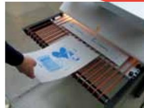
Le lastre scritte, vengono inserite nella unità di finissaggio intergrata al sistema e posizionata sotto i piani di uscita lastra. L'unità di cottura asciuga e fissa il Liquid Dot™ alla superficie della lastra ed in automatico la trasferisce nell'unità di gommatura per una migliore protezione della lastra.
